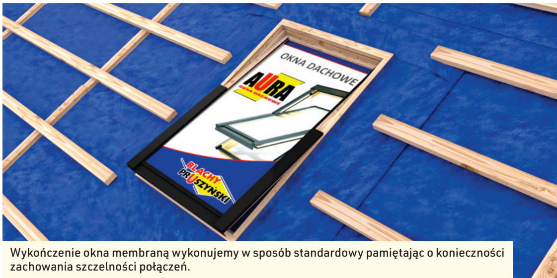
Podkonstrukcja okna dachowego
