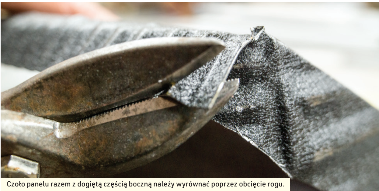
Niedociągnięcia można poprawić za pomocą szczypiec.
