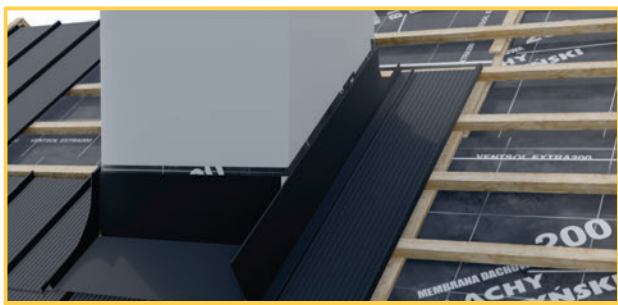
Obróbkę boczną „łączymy” z arkuszem za pomocą zaginadła ręcznego.
