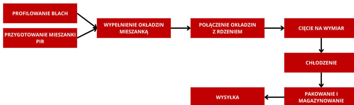
Rysunek 4.1: Uproszczony schemat produkcji płyt warstwowych z rdzeniem typu PIR
