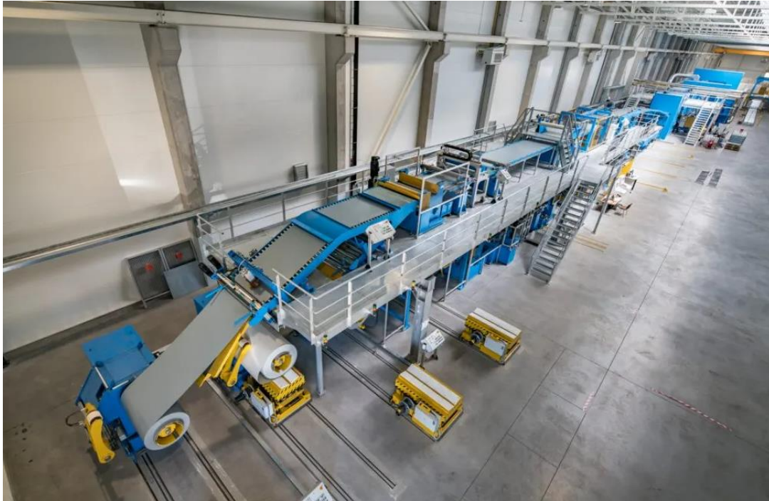
Rysunek 3.3: Linia technologiczna do produkcji ściennych oraz dachowych płyt warstwowych z rdzeniem PIR
