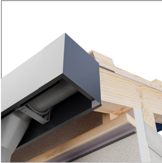
Montaż listwy J do drewnianej łąty. Zalecamy montaż na zszywki do blachodachówki.
