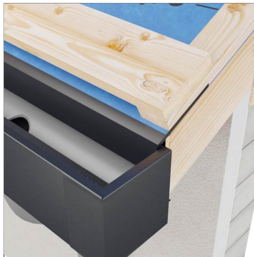
Montaż podkonstrukcji według instrukcji montażu pokrycia dachowego. Zalecane wymiary łąt i kontrłąt - 40 x 60 mm.
