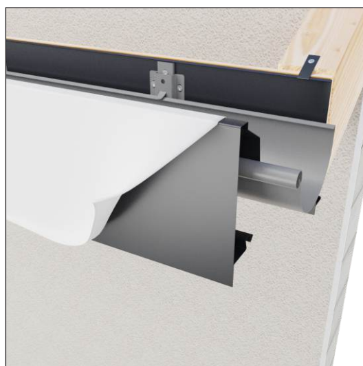
Zrywanie folii ochronnej po zapięciu maskownicy w uchwyty.
