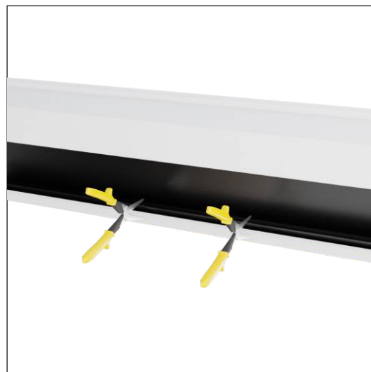
Maskownicę podcinamy tylko do przetłoczenia jak na obrazku, a do cięcia używamy lewych/prawych nożyc do metalu.
