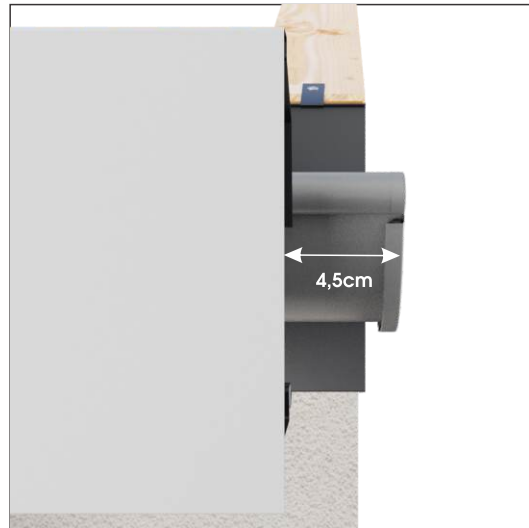
Maskownica powinna być montowana około 4,5cm od końca rynny. W przeciwnym razie nie zamontujemy zaślepek maskownicy. Montaż powinien odbywać się z naklejoną folią ochronną.
