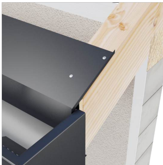
Montaż obróbki okapu.
