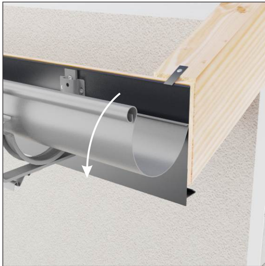
Montaż orynnowania w hakach.
