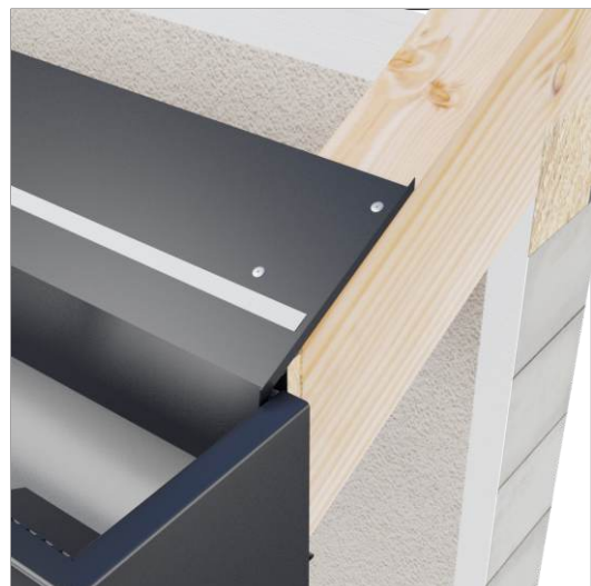
Przyklejenie taśmy dwustronnej do obróbki.
