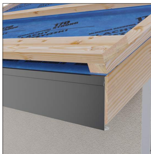
Montaż podkonstrukcji według instrukcji montażu pokrycia dachowego. Zalecane wymiary łąt i kontrłat - 40 x 60 mm.
