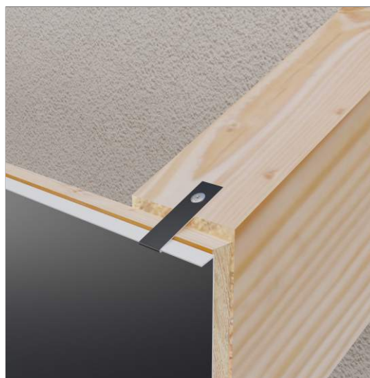
Obudowa u góry mocowana za pomocą haczyka do krokiew.
