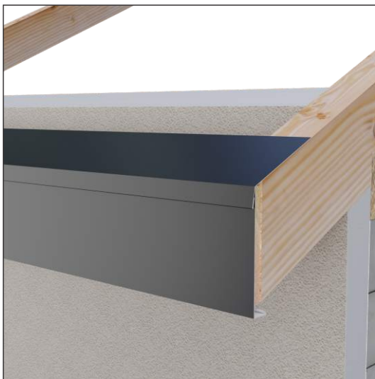
Montaż pasa podrynnowego (skroplinowego).
