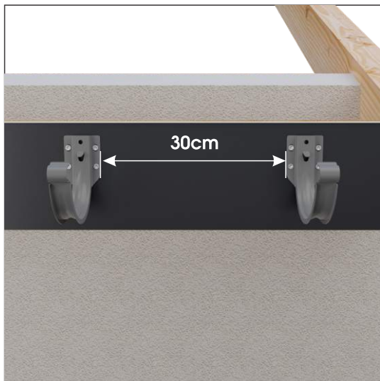
Rozstaw haków w miejscu montażu sztućera powinien wynosić minimum 30 cm.
