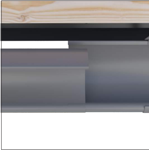
Rynny łączone z zakładem.
