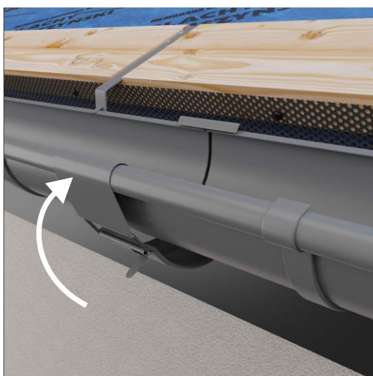
Przednią część złączki zakładamy na wulstę
