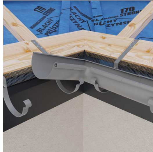
Rynna z narożnikiem układana na hakach po jednej stronie narożnika.
