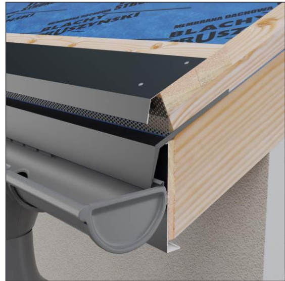
Montaż pasa nadrynnowego.
