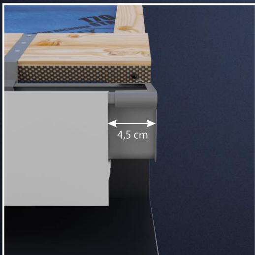
Maskownica powinna być montowana około 4,5 cm od końca rynny. W przeciwnym razie nie zamontujemy zaślepki maskownicy. Montaż powinien odbywać się z naklejoną folią ochronną.
