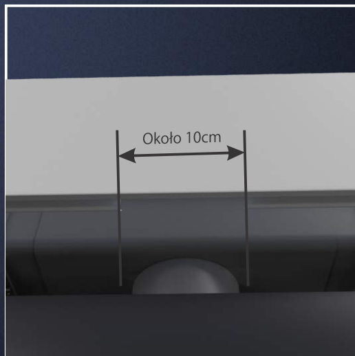
Wycięcie na spust sztucera powinno mieć około 10 cm szerokości.
