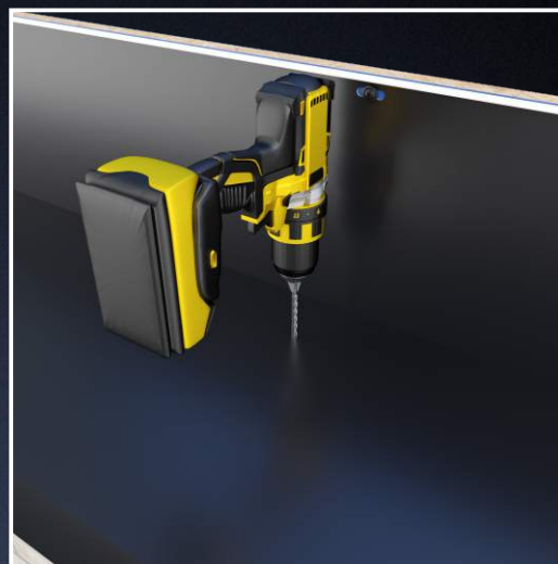
Wykonanie w obróbce otworu pod nożyce.
