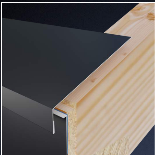
Montaż pasa podrynnowego (skroplinowego).
