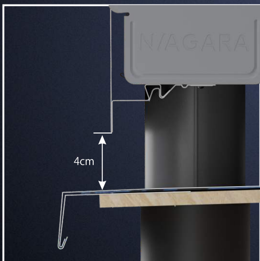
Odległość między maskownicą a parapetem powinna wynosić 4cm. Wymiar ten wynika z wysokości zastosowanej kontrłaty.
