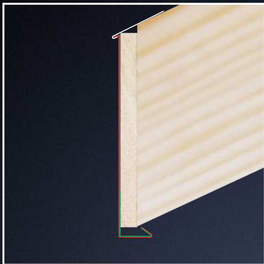
Przekrój poprzeczny po montażu pasa podrynnowego.
