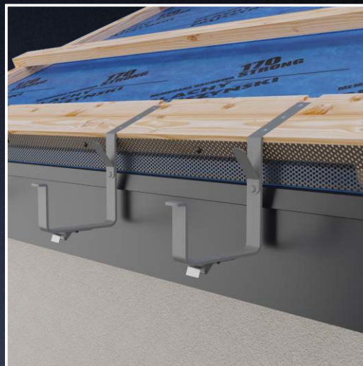
Montaż haków nakrokwiowych w zagłębieniach łąty.
