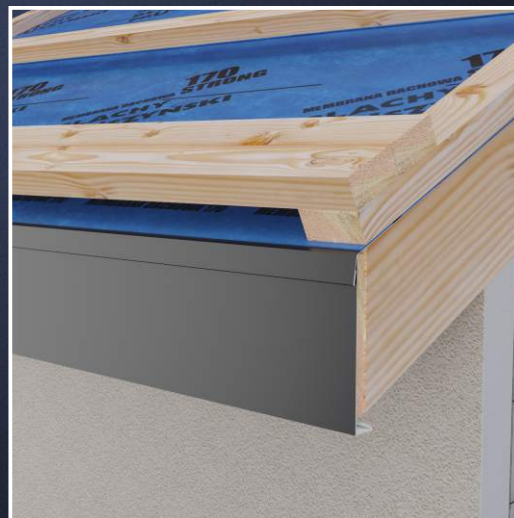
Montaż podkonstrukcji według instrukcji montażu pokrycia dachowego. Zalecane wymiary lat i kontrłat - 40 x 60 mm.
