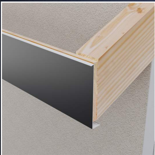
Zaczeplenie obudowy o listwę startową. Dolne zagięcie umożliwia montaż podbitki na obróbce - patrz montaż podbitki na stronie 25.
