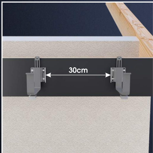
Rozstaw haków w miejscu montażu sztucera powinien wynosić minimum 30 cm.
