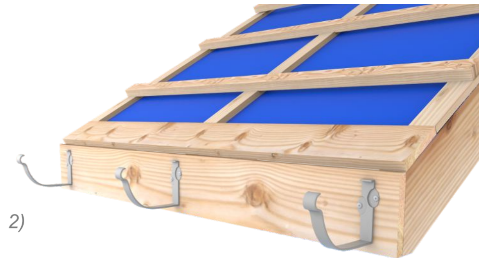
Przykład zastosowania haków rynnowych montowanych bezpośrednio do krokwi lub deski okapowej (1) lub haków combi (2) mocowanych do deski czołowej.
