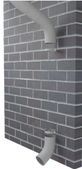
Rozplanowanie obejm rury spustowej
