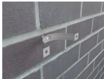
Montaż obejmki do ściany odbywa się za pomocą kotła rozporowego i śruby.
