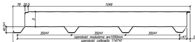
Rys.2. Schemat podstawowy płyty (rysunek dostarczony przez zleceniodawcę)
