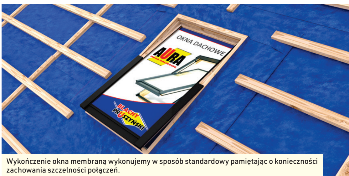
Podkonstrukcja okna dachowego
