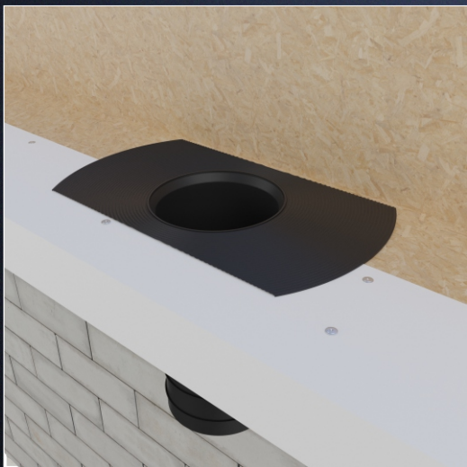
Podklejona gilza założona na płytę OSB.
