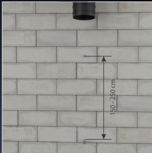
Mocujemy w ścianę kołki do montażu rury spustowej. Kołki umieszczamy w odległości od 150 do maksymalnie 250cm od siebie. W ofercie posiadamy kołki do obejm o długościach 100, 160, 200, 250 oraz 300 mm.
