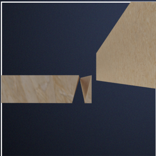
Płytę montowaną poziomo przycinamy piłą pod kątem, tak aby po połączeniu płyt utworzył się spadek. Spadek powinien wynosić 4mm na każde 20cm głębokości parapetu
