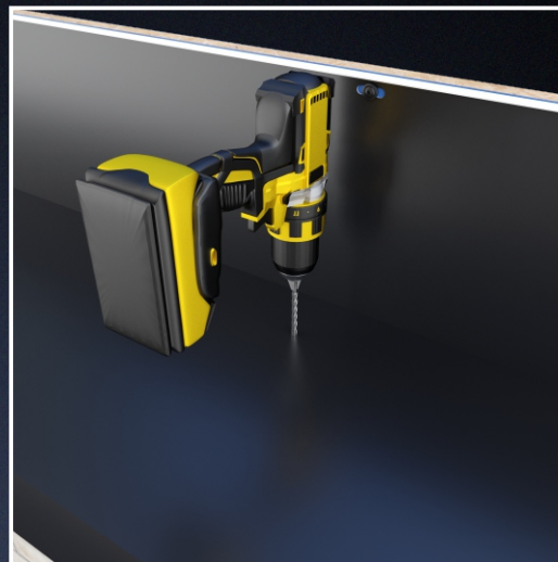
Wykonanie w obróbkę otworu pod nożyce.
