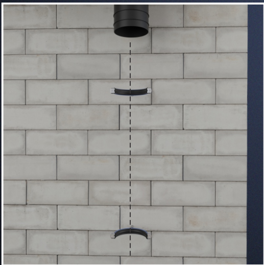
Blaszki powinny być umieszczone w jednej linii z wylewką sztucera i pod kątem 90° do okapu. Pierwsza obejmą powinna znajdować się w odległości 50 do 100cm od okapu.
