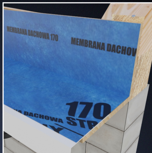
Montaż membrany dachowej na półce i desce doczołowej.
