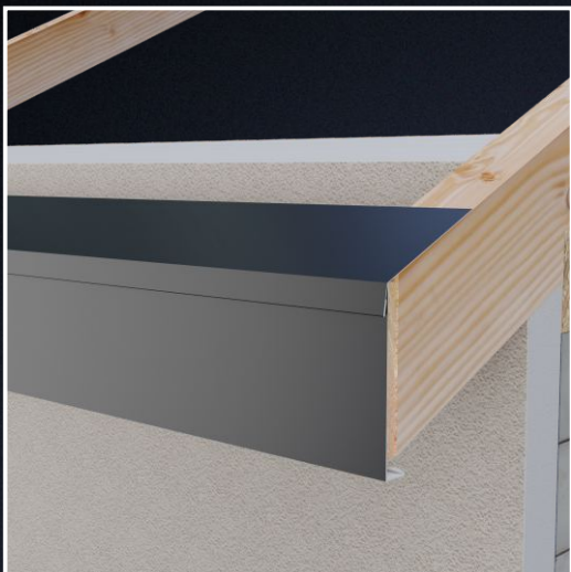
Montaż pasa podrynnowego (skroplinowego).
