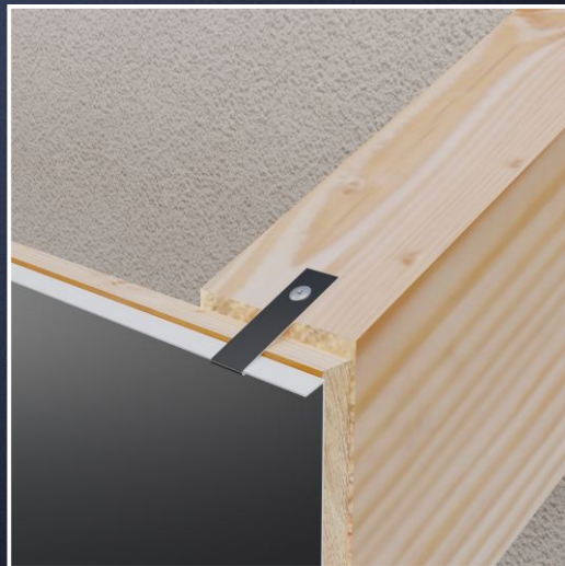
Obudowa u góry mocowana za pomocą haftr do krokiew.
