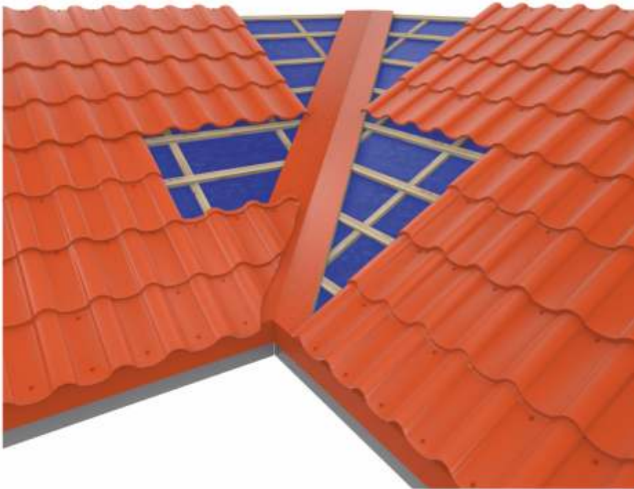
Przykładowa kolejność montażu dachówki przy rynnie koszowej
